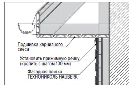
*Вариант, когда плоскость фасада переходит в крышу, решается при помощи карнизной планки как показано на рисунке:*
